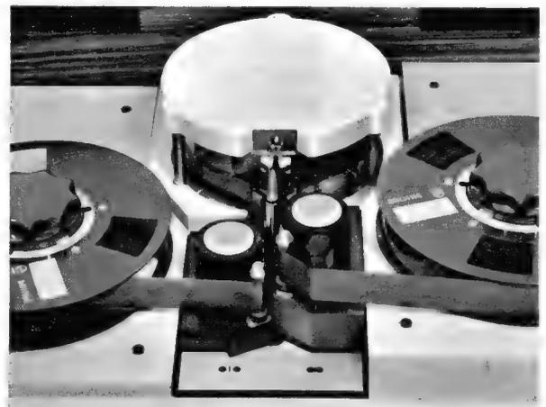
Rechts: Bild 2. Die Bandführung; der im Vordergrund sichtbare Schließhebel ist geöffnet. In dieser Stellung wird das Magnetband eingelegt. Ist der Schließhebel geschlossen, so pressen die Gummidruckrollen das Band an die Bandantriebswelle (375 U/min = Bandgeschwindigkeit 19 cm/sec. Vor der linken Gummirolle sitzt der Löschkopf
