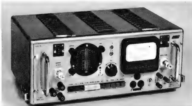
Der Geschwindigkeits-Schwankungsmesser V.F.R. 3 der Firma Laboratoire Electro-Acoustique
