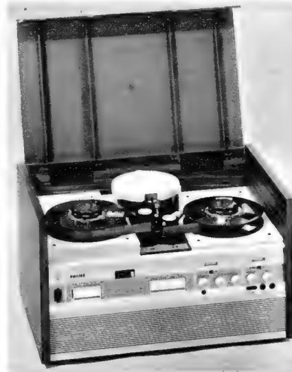
Bild 1. Magnetband-Aufzeichnungsgerät Philips-Video-Recorder 3400 für Bild und Ton von Fernsehdarbietungen. Das Gerät ist für vielseitige Anwendung im professionellen/kommerziellen Bereich gedacht
