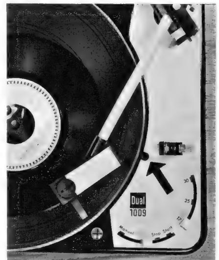
Bild 4. Die rechte Vorderseite des Plattenwechslers mit der durch einen Pfeil markierten Schraube zum Justieren des Aufsetzpunktes
